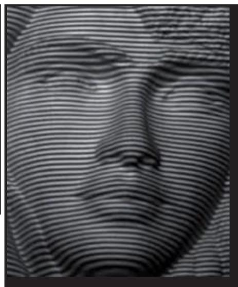
y un haz láser que junto con el objeto, forman un triángulo. A partir de ese triángulo y aplicando técnicas de geometría podemos obtener la posición de cada punto del objeto. En la mayoría de casos este escáner se puede visualizar como una raya de láser, en vez de un punto de láser, que barre el objeto en la adquisición de datos.
